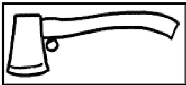
Num machado bem alinhado, o gume da lâmina deve estar em linha com a ponta do cabo.
